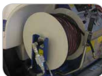
Naspo HP idraulico fisso + guida. Max tubo 100 mt 1/2" - 60 mt 3/4".
